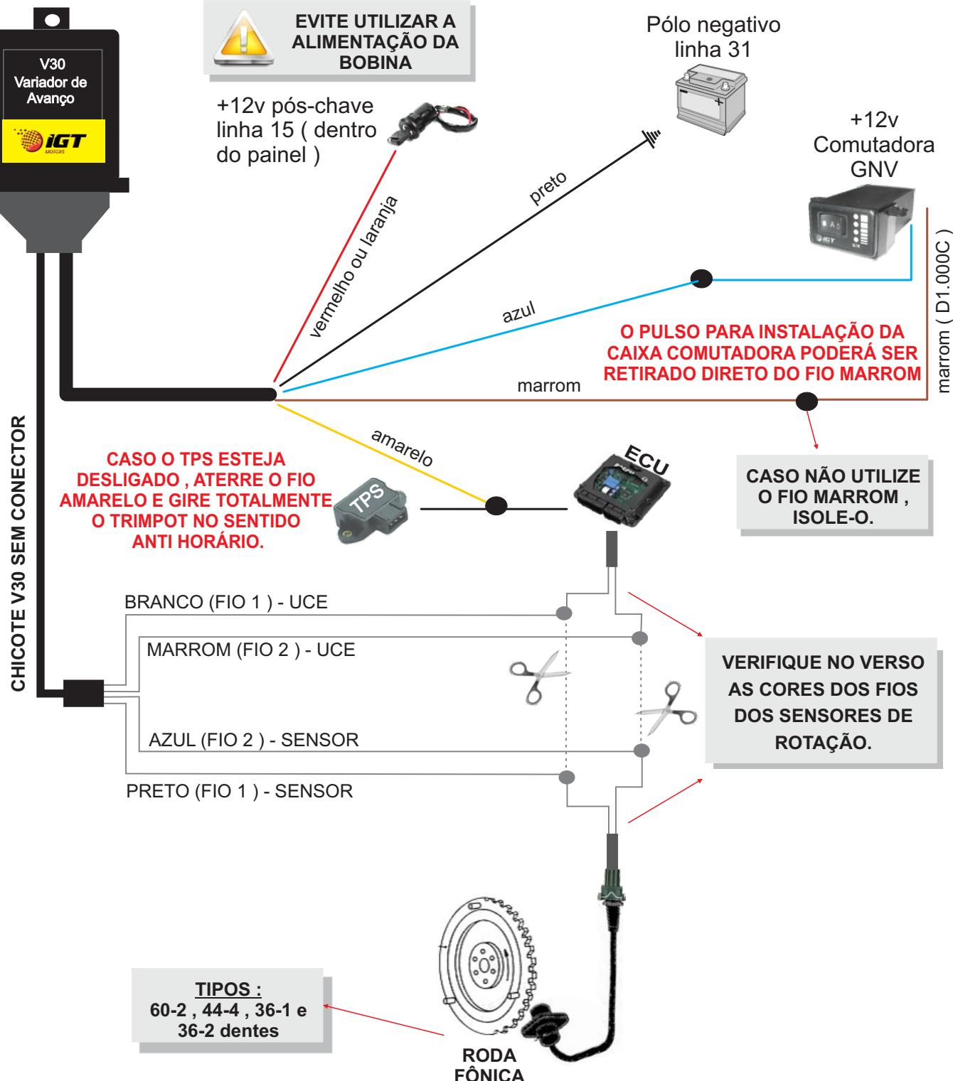
EM CASO DE ACCELERADOR ELETRÔNICO , CONECTAR O FIO AMARELO NO SINAL DO SENSOR DE POSIÇÃO DO PEDAL DO ACCELERADOR. NUNCA CONECTAR O FIO AMARELO NO CORPO DO ACCELERADOR ELETRÔNICO DO TBI DO MOTOR.
